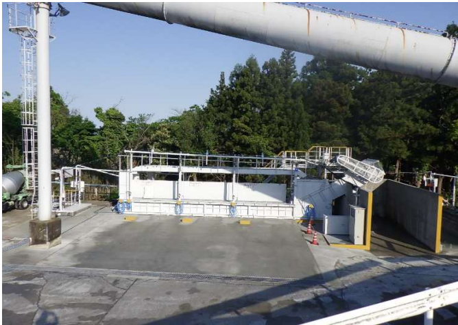
[ ミキサ車残水処理装置 ]
